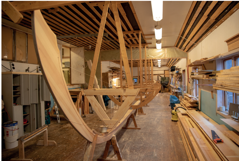
Den 18,5 meter långa kölen är sträckt. De åtta mallarna är på plats. Fören eller "Ansiktet" närmast kameran. Båten blir något bredare i fören än i aktern.
