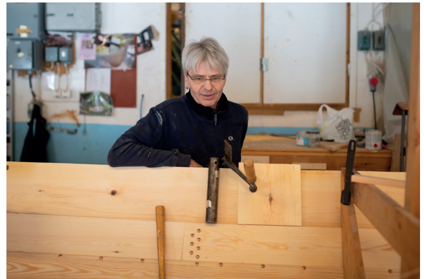
Arne Håll. Bordläggningen fortsätter. Tätning görs med bomullsgarn. Tidigare användes lin. Bordläggningen fästs med kopparnitar. 2130 st till en kostnad av 12000 kr.
