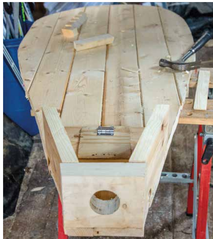
Bild på bälgens översida med backventil. Foto: Lars Hansson.
