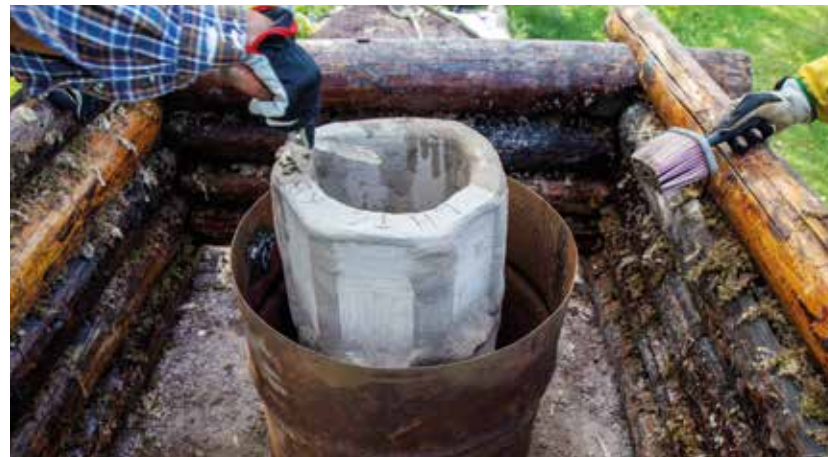
Ugnen är nästan klar. Det fattas uttag för slaggtömning och anslutning av bälgen. Foto: Lars Hansson.
