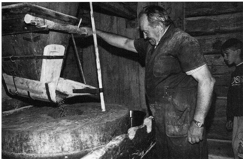
Mjöllnaren Bond Erik Persson kontrollerar att kvarnstenarna matas jämnt.
