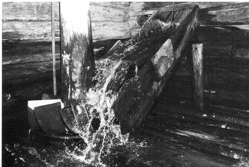
I kvarnbyggnades undre del forsar vatten från påsläppet mot kvarnvingarna, via kvarnstensaxeln drivs stenarna runt.
