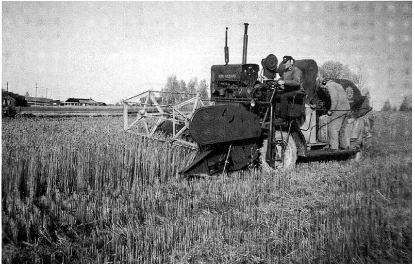
En av de tidigare skördetröskorna på Sollerön körs av Håll Nils Matsson 1984. Det var en s.k. säcktröska. Medhjälparen Bo Andersson till höger tar emot spannmål i säckar. De senare modellerna var betydligt större och med hytt för föraren och tank för spannmålen.
