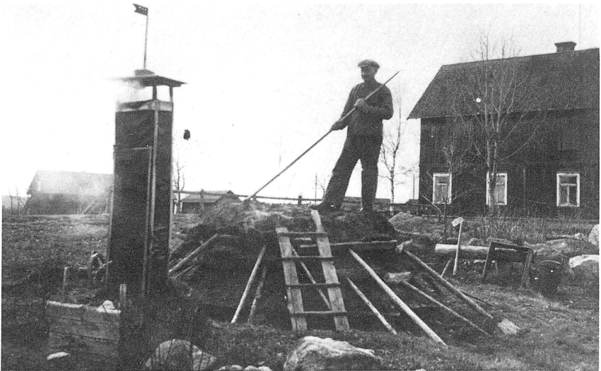
Rull Anders vaktar sin specialkonstruerade mila, där han framställde kol till smedjan. I bakgrunden t.h. syns hans stuga med köksfönstret i mitten. Därifrån kunde han kontrollera vindriktningen tack vare vimpeln på milans skorsten. I bakgrunden t.v. syns föräldrahemmet som brodern Rull Jöns övertog.
