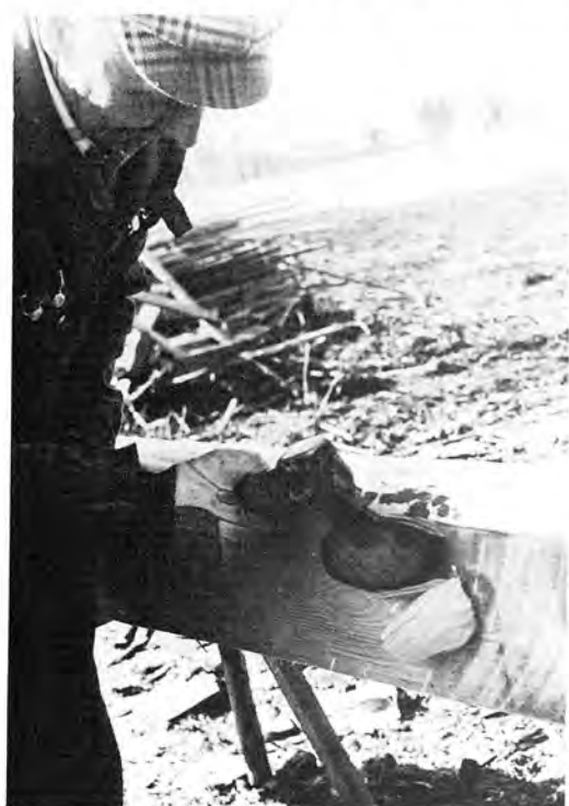
Här jämnhylas stockens över- och undersidor med en eldriven kutter.
