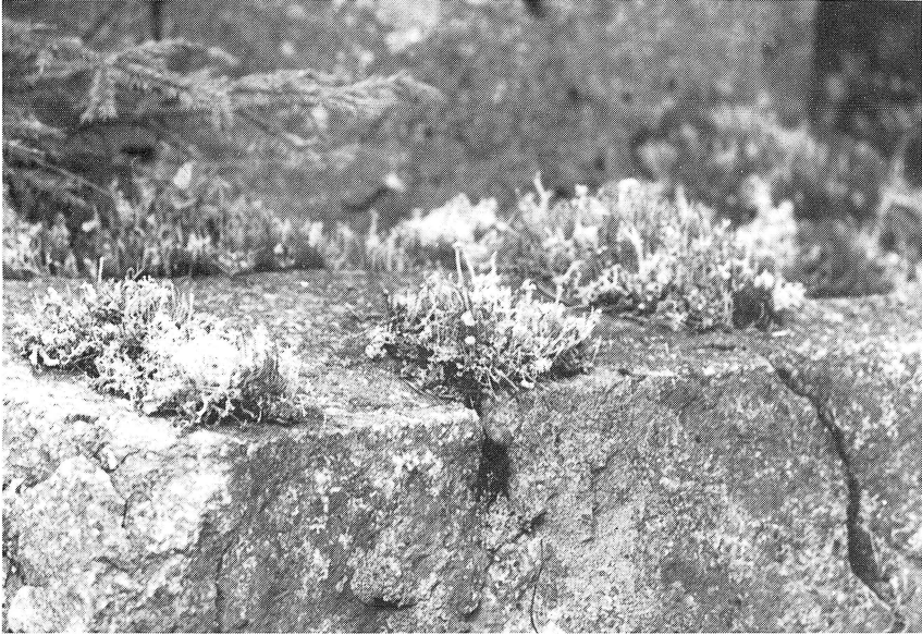
Detalj som visar granitens goda egenskap att spricka i tre plan och bilda kubiska block.
