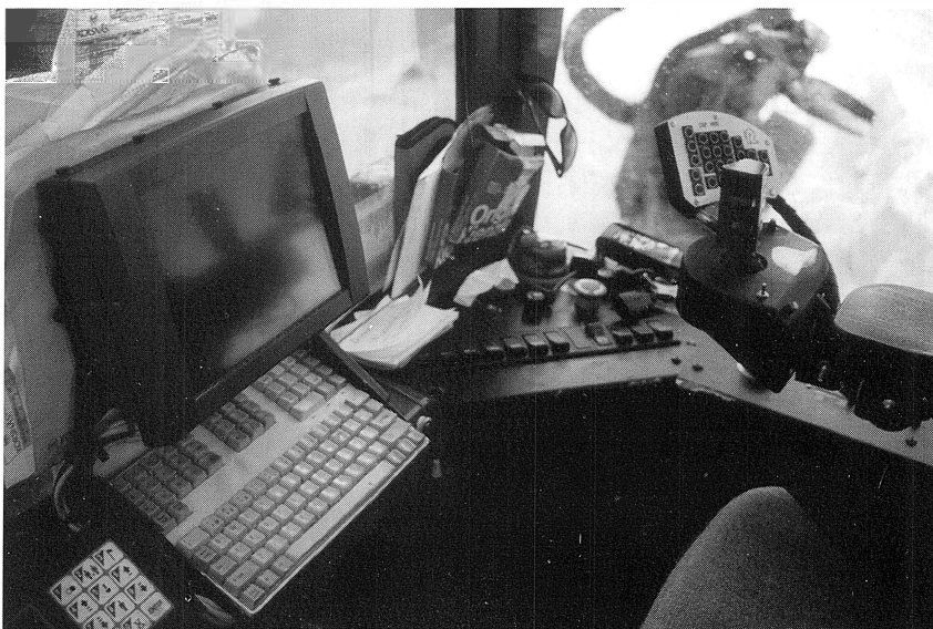
Skördarens hytt med dataanläggning för inprogrammering av t.ex. virkeslängd, dimensioner, kvistning m.m. Dessutom finns en panel för manövrering av maskinen.
