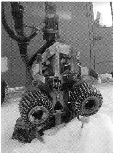
Skördarhuvudet med knivar för kvistning och griphjul för stammarna. På bilden är kapsågen dold bakom skördarhuvudet.
