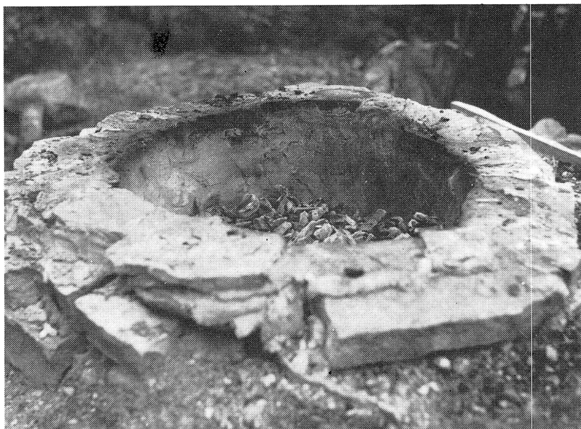
Rekonstruerad ugn vid Gryvelån i Alvdalen. Ugnen är till 2/3 fylld med kol, malmen har börjat påföras och blåsverket är i gång.
